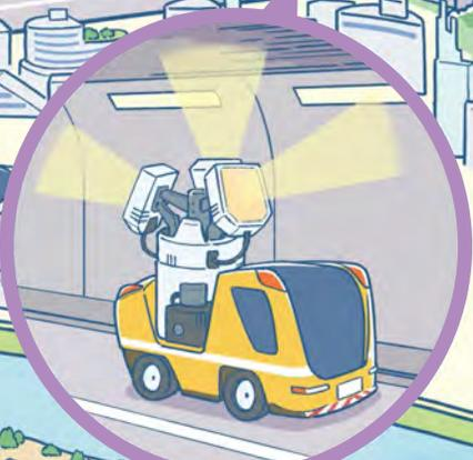
走行型のトンネル点検・舗装診断
