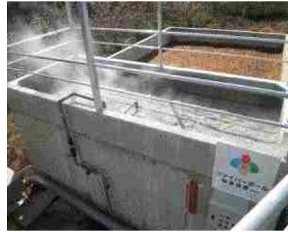
密閉型堆肥化装置に設置
