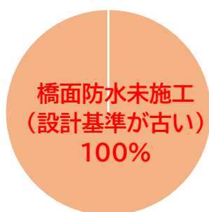
【PCT 桁にひびわれが発生している橋梁の橋面防水施工状況】
