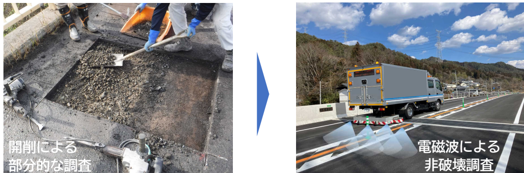
写真 2-3 従来点検と新技術(電磁波による非破壊調査)を活用した点検の比較
