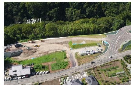
令和5年度末の完成に向け、三島地区では舗装工・安全施設工、岩下・松谷地区で道路改良、舗装、安全施設工事を実施しております。
