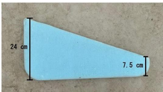
図 2 堰板 (発砲スチロール建材)
