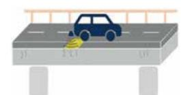
車両から出す電磁波を使って橋梁点検をするイメージ
