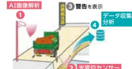
光変位センサーを用いた、橋梁の劣化を早める過積載車両を監視するシステム
