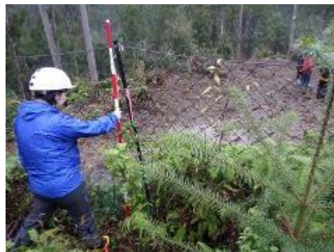
図 4-12 防護柵の高さを示す写真の例
