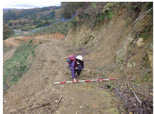
図 4-15 作業道の幅員を示す写真の例
