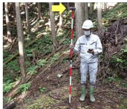
測量ポールの先端に取り付けられた GNSS機器
