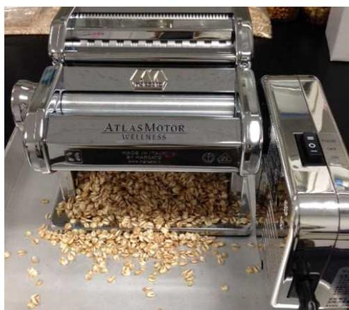
図5 家庭用製麵機を利用した押し麦製造
