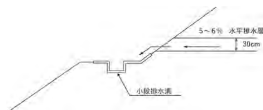
図 14-12 水平排水層端末部
