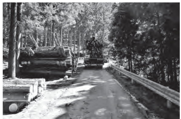
林道、作業道を利用した木材の集積・搬出作業
