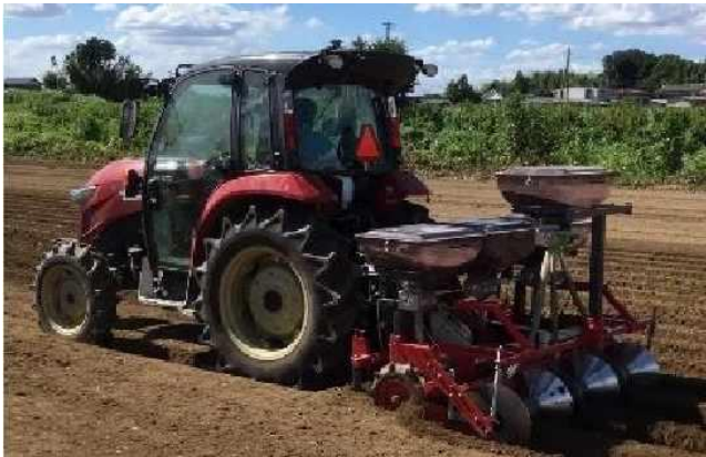
直進アシストトラクターと局所施肥機の組合せによる 作業労力と化学肥料使用量の低減
