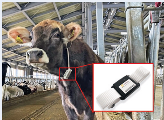
発情監視システムの首輪型センサー
