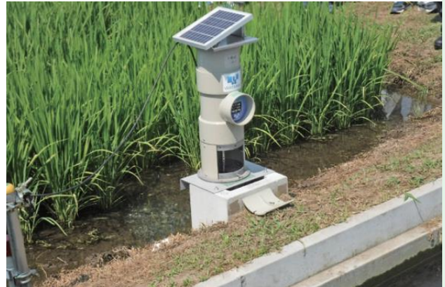
スマート農業技術の導入（自動給水栓の設置）
