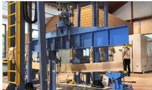
実大強度試験機による試験状況(林業試験場)
