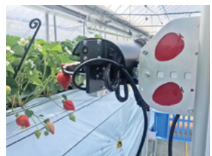
いちご自動収穫ロボットの实証
