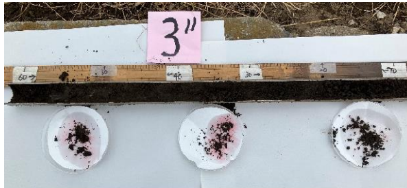
写真5-12 ジピリジル試薬による還元化確認 (赤色が還元化による反応)
