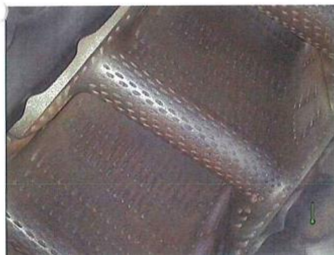
写真(23) 燃料ノズル取外し箇所より 高圧タービン1段静翼
