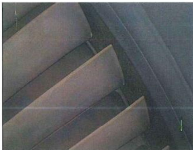
写真(32) ボアスコープポート#10Dより 高圧タービン2段動翼外端
