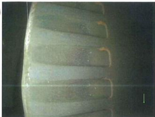
写真(25) ボアスコープポート#12より 高圧タービン1段静翼腹面
