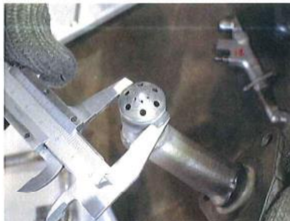
【燃料ノズル噴口部磨耗量計測状況】
