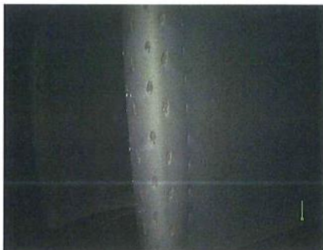
写真(26) ボアスコープポート#12より 高圧タービン1段動翼前縁
